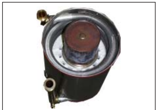
Рис.: Выдвинуть изоляцию с горелкой
