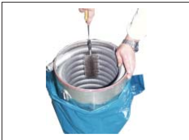
Рис.: Чистка теплообменника
