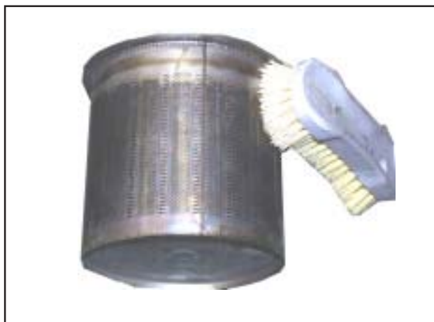
Рис.: Чистка горелки
