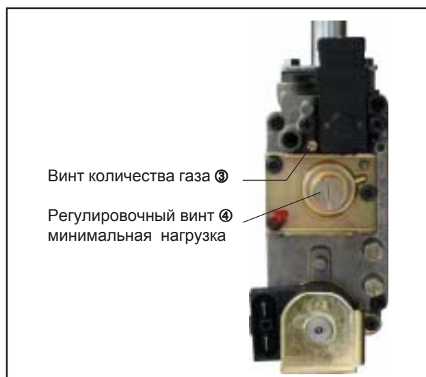
Рис.: Установка значений CO 2
