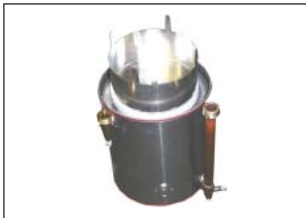
Рис.: Стакан камеры сгорания вставить в теплообменник снизу
