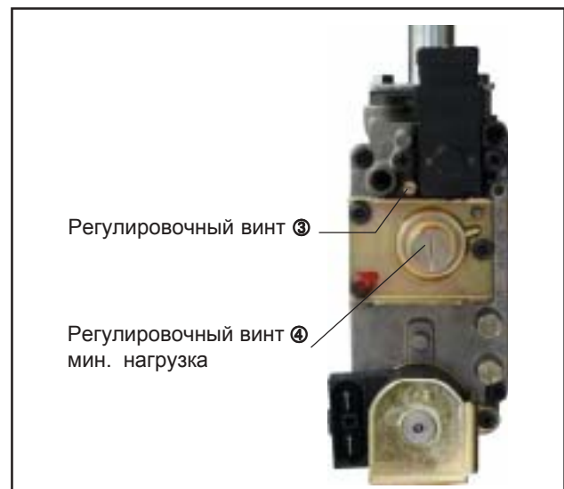
Рис.: Регулировка содержания CO 2
