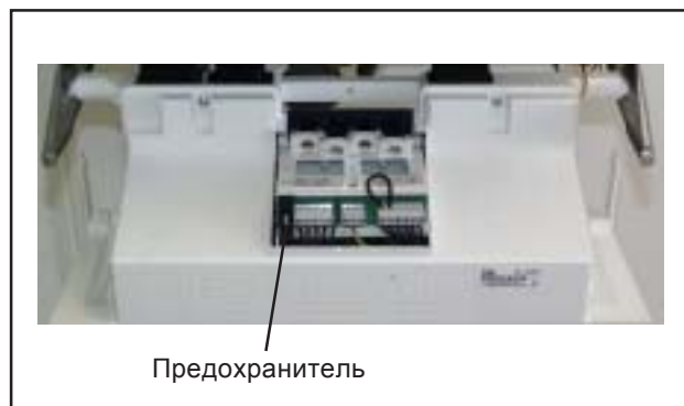
Рис.: Замена предохранителя
