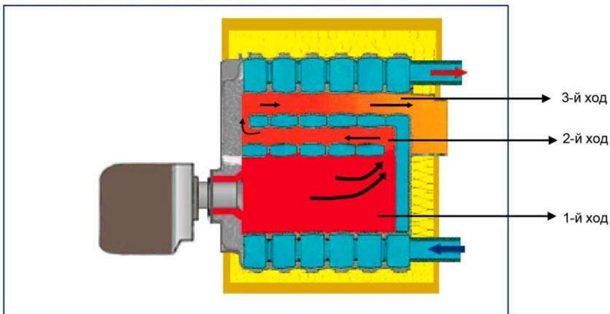
Чугунный секционный котёл, сконструированный по принципу вертикальной трехходовой циркуляции дымовых газов
