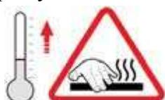
Не касайтесь линий подключения горячей воды или контура дымохода при работе котла, это может привести к ожогу.
