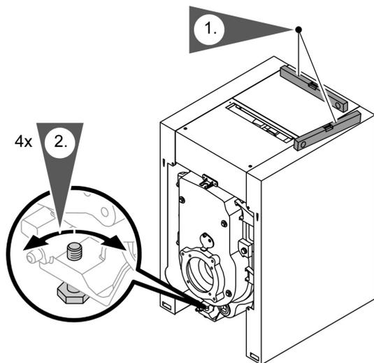
Установить водогрейный котел с небольшим подъемом задней части.
