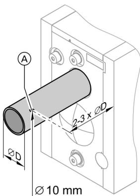
1. Соединить патрубок отходящих газов кратчайшим путем и с небольшим подъемом с дымовой трубой.
