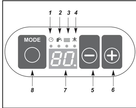
1. Светодиод давления в контуре отопления: индикация давления теплоносителя
