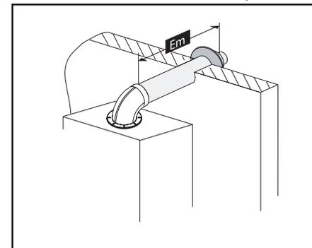
При использовании отдельных труб (80 мм) для горизонтальных трасс с горизонтальными выводами подача воздуха и вывод продуктов сгорания от этого котла должен быть выполнен так, чтобы оба они находились внутри квадрата с длиной стороны 0,5м.
