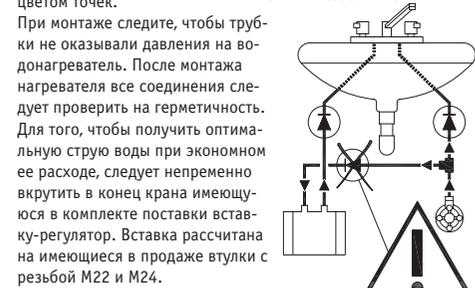
При монтаже следите, чтобы трубки не оказывали давления на водонагреватель. После монтажа нагревателя все соединения следует проверить на герметичность. Для того, чтобы получить оптимальную струю воды при экономном ее расходе, следует непременно вкрутить в конец крана имеющуюся в комплекте поставки вставку-регулятор. Вставка рассчитана на имеющиеся в продаже втулки с резьбой M22 и M24.
