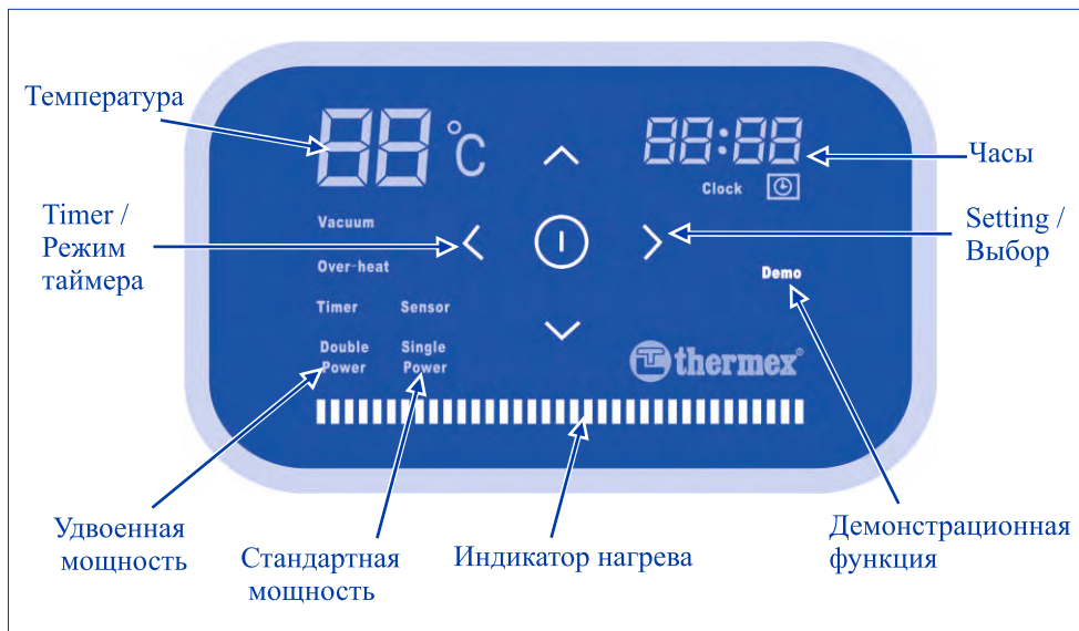
Рис. 6. Электронная панель управления (вариант 2)
