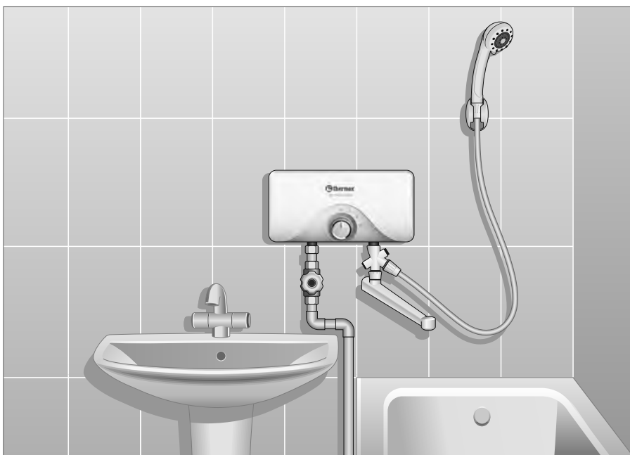
Рис. 2. Возможные варианты установки ПЭВН
