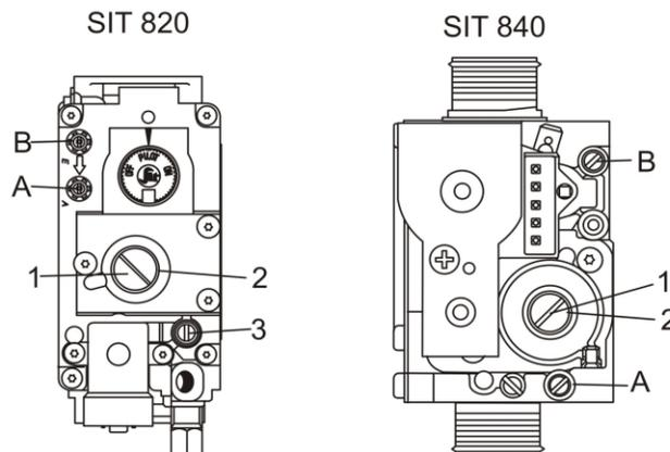
Для настройки газового клапана необходимо произвести следующие действия:
