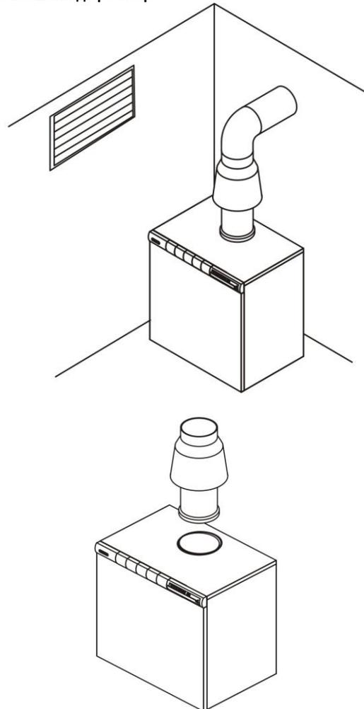
При применении внешнего дефлектора сенсор термостата дымовых газов следует установить в дефлекторе, следуя рисунку. Во избежание выскальзывания сенсора термостата затяните его эксцентрическим винтом.
