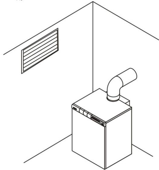
Котлы серии KRAFTER 50, -60 .. ..следует подключить к дымоходу через внешний дефлектор.
