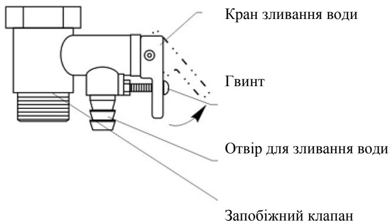
Щоб уникнути поломки при загвинчуванні запобіжного клапана не застосовуйте великих зусиль.
