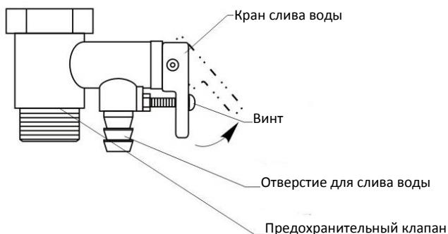
Во избежание поломки при завинчивании предохранительного клапана не применяйте больших усилий.
