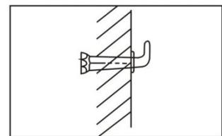
3. Подвесьте водонагреватель за кронштейн корпуса на крюки анкерных болтов. Убедитесь в том, что нагреватель надежно закреплен.
