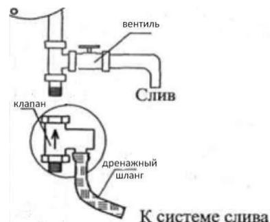
Появление капель воды из отверстия предохранительного клапана во время нагрева воды является естественным процессом и связано с расширением воды в баке при нагревании. Отверстие клапана советуем соединить отводной гибкой трубкой с системой слива.
