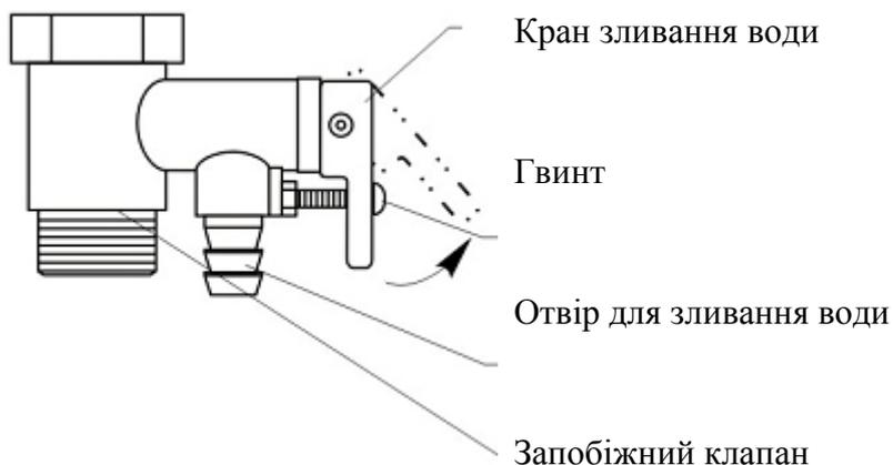
Щоб уникнути поломок при загвинчуванні запобіжного клапана не застосовуйте великих зусиль.
