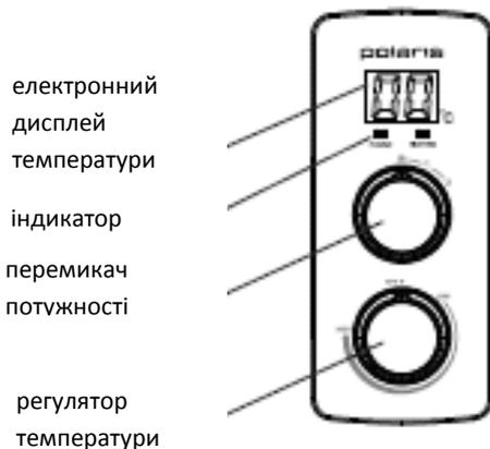
1. За допомогою перемикача потужності встановіть необхідну потужність (1500Вт /2500Вт). Від вибору потужності залежить швидкість (час) нагрівання води до заданої температури. При вмиканні перемикача потужності в позицію «1» прилад працює з потужністю 1500Вт. При вмиканні перемикача потужності в позицію «2», прилад працює з потужністю 2500Вт. Індикаторна лампочка, що світиться, означає нагрівання води.
