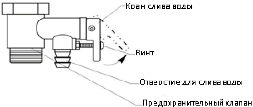
Во избежание поломки при завинчивании предохранительного клапана не применяйте больших усилий.
