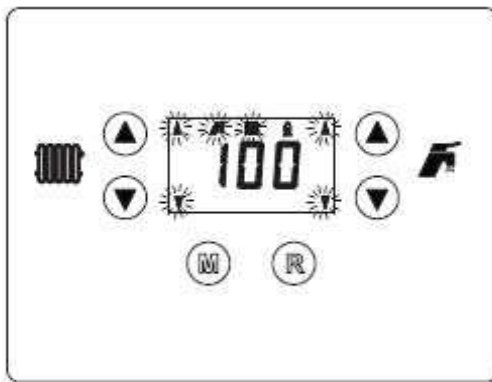
Рис. 17 – Режим ТЕСТ (мощность отопления – 100%)
