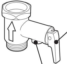
Рычаг предохранительного клапана
