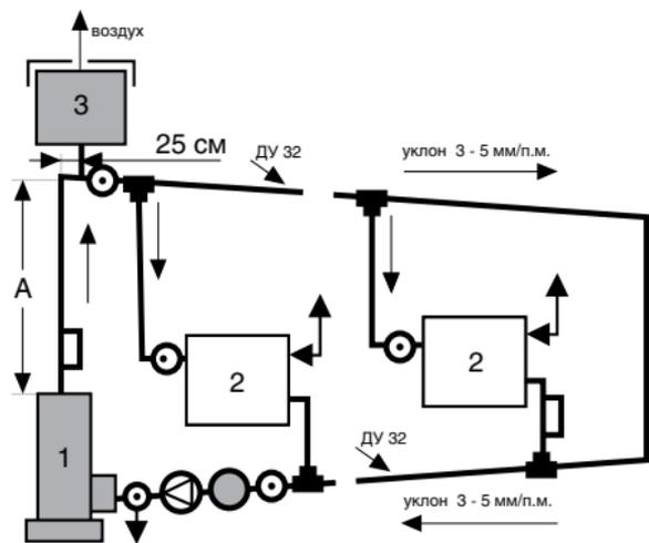
Рис. 1 Система отопления с верхним розливом.
