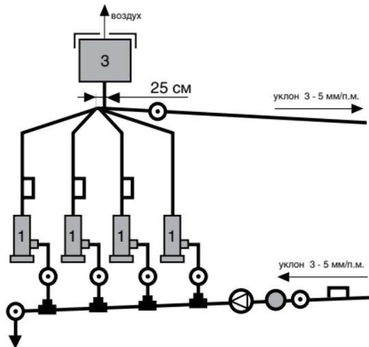
Рис. 2 Параллельное подключение.
