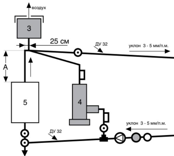
Рис. 3 Подключение резервного электродного котла.
