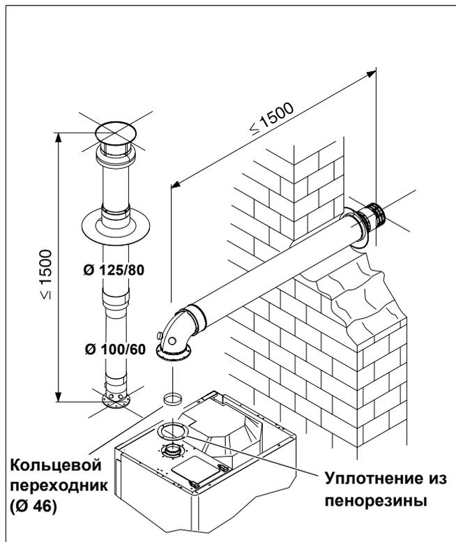
Рис. 17 Установка кольцевого переходника и системы отвода дымовых газов (размеры в мм)
