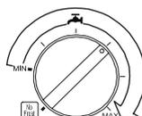
Если поворотный переключатель находится в пределах стрелки, то температура горячей воды регулируется в диапазоне между минимальной 25 °С и максимальной 60 °С.
