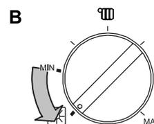
Для перевода газового циркуляционного водонагревателя в **летний режим** и только для приготовления горячей воды нужно перевести переключатель (рис. 52, поз. В) в положение
