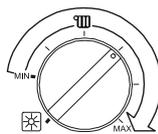
Если поворотный переключатель находится в пределах стрелки, то водонагреватель работает в режиме приоритетного приготовления горячей воды (если это требуется), и температура в отопительном контуре регулируется в диапазоне между минимальной 45 °С и максимальной 80 °С.
