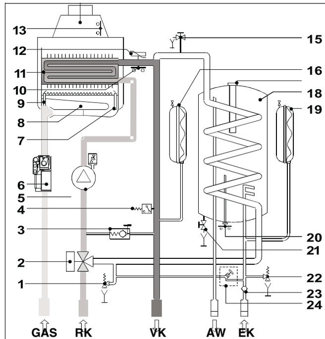
Рис. 4 Logamax U014-28 T60 – в режиме отопления
