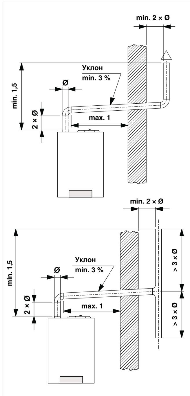
Рис. 9 Подключение к дымовой трубе (размер в мм)
