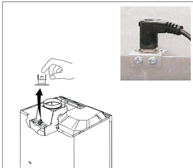
Рис. 10 Система контроля дымовых газов
