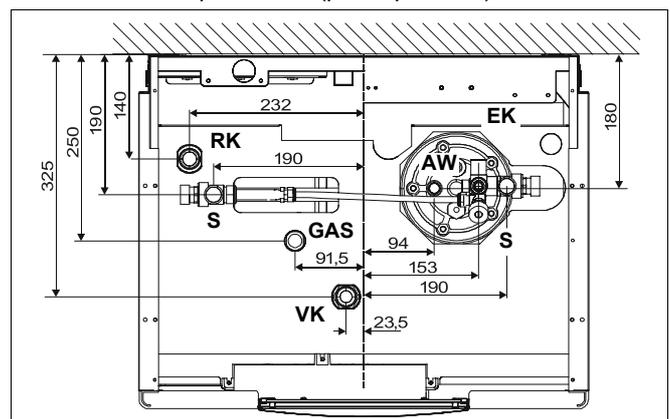
Рис. 8 Размещение подключений. Вид сверху (размеры в мм)
