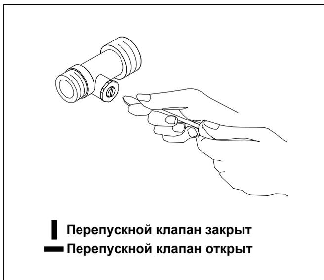
Рис. 29 Настройка перепускного клапана
