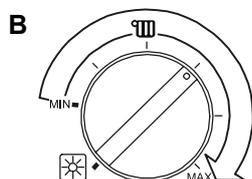
Для перевода газового циркуляционного водонагревателя в **зимний режим** можно установить переключатель (рис. 52, поз. В) в диапазоне по всей длине стрелки, указанной на верхнем рисунке.
