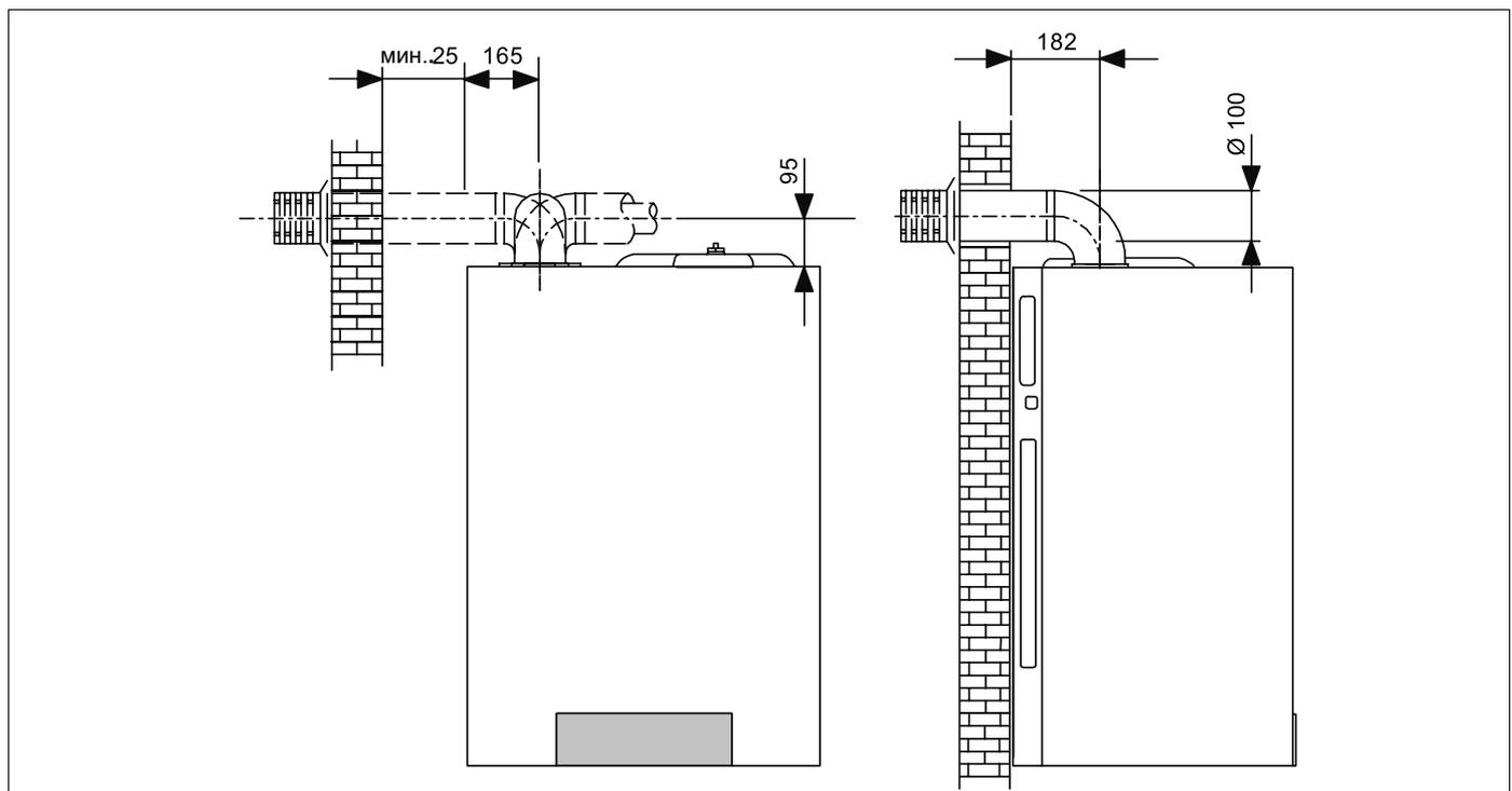
Рис. 22 Размеры для подсоединения концентрического дымохода (в мм)
