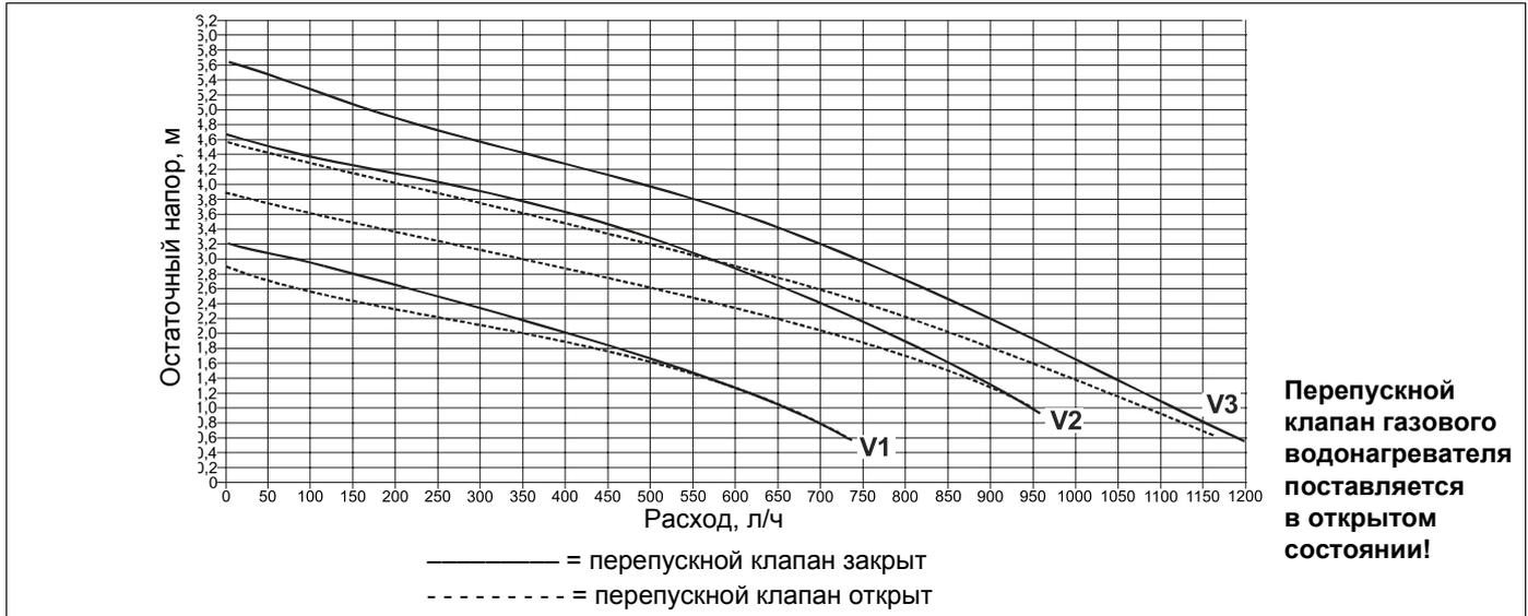
Рис. 30 Остаточный напор циркуляционного насоса
