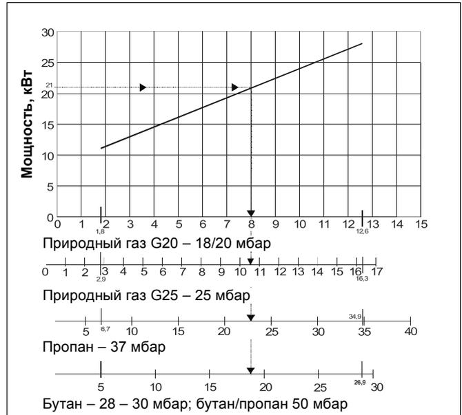
Рис. 49 Зависимость давления горелки от мощности котла
