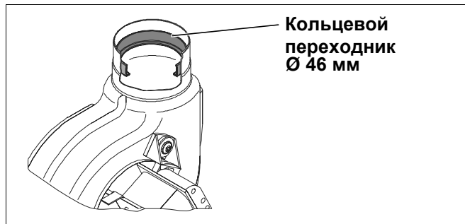
Рис. 21 Подгонка кольцевого переходника
