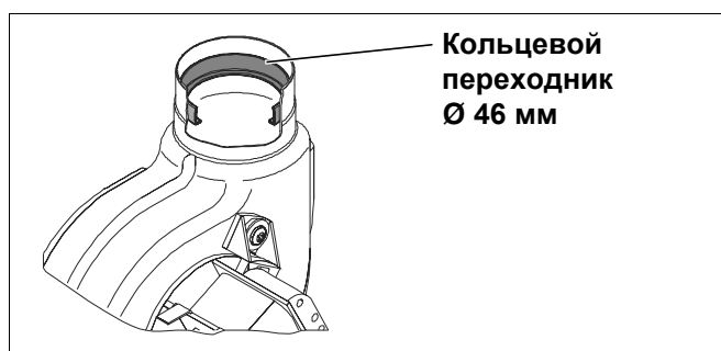
Рис. 19 Подгонка кольцевого переходника
