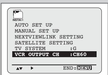
*Возможно, вам придется изменить выходной канал видеомагнитофона, если изображение искажено помехой или телевизор не может найти изображение. Вы также можете изменить выходной канал видеомагнитофона для подстройки частоты, на которой производится передача информации для отображения на экране.*
