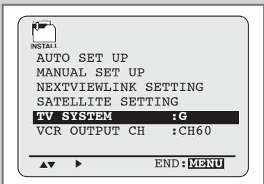
*Вы можете выбрать режим звукового сопровождения (B/G-D/K) в зависимости от типа подключенного к видеомагнитофону телевизора.*
