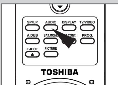
*Нажатие кнопки AUDIO при просмотре телевизионной программы или прослушивании Hi-Fi видеокассеты даёт возможность выбрать звуковой режим. При каждом нажатии звуковой режим меняется в порядке, указанном ниже.*
