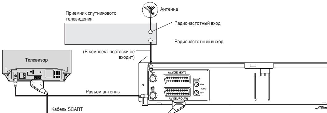
Поставьте приемник спутникового телевидения на видеомагнитофон, как показано ниже. Не закрывайте при этом окно датчика.
