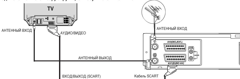
При подключении другого видеомагнитофона, поддерживающего функции EasyLink/nexTViewLink/AV-Link: Система "nexTViewLink" может подключать 2 видеомагнитофона (VCR1 и VCR2) одновременно. Данный видеомагнитофон настроен как "VCR1", поэтому его необходимо подключать к видеомагнитофону VCR2.
