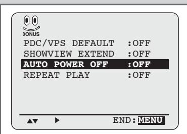
**Функция автоматического выключения питания автоматически выключает видеомагнитофон, если нет приема сигнала и в течение заданного времени не действует ни одна кнопка.**
