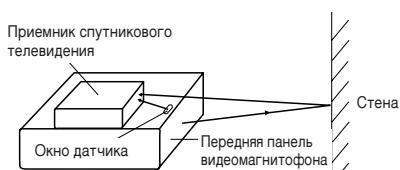
Излучение инфракрасных сигналов происходит из окна датчика и с передней панели видеомагнитофона. Затем они отражаются от стен и различных предметов, находящихся в помещении, и поступают на приемник спутникового телевидения.
