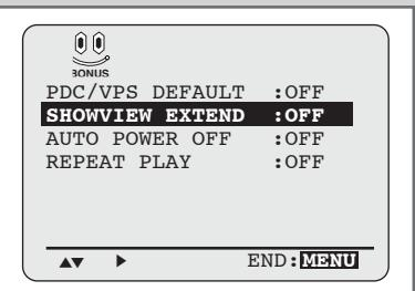
Чтобы предотвратить задержки или наслаждение передач, видеомагнитофон снабжен функцией так называемого РАСШИРЕННОГО ShowView, позволяющей продлить до 60 минут время записи.
