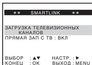
**3** Нажмите **↑/↓** для выделения ЗАГРУЗКА ТЕЛЕВИЗИОННЫХ КАНАЛОВ, затем нажмите **→**. Нажмите **→** еще раз. Функция загрузки предварительно установленных данных начнет работу и индикатор
