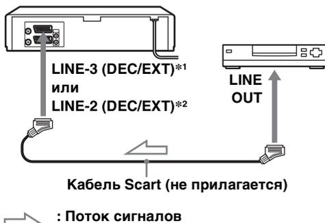
видеомагнитофону, даже если видеомагнитофон выключен. Если Вы включите спутниковый или цифровой тюнер, данный видеомагнитофон автоматически начнет посылать сигнал от спутникового или цифрового тюнера на телевизор без включения.
