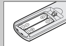
**3** Возвратите крышку отсека для батарей на место, совместив ее с направляющими на пульте и сдвинув ее до упора.
