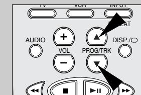
*Функция точной настройки позволяет вам вручную подстроить трекинг для получения наилучшего возможного изображения.*
