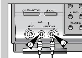
1 Соедините один конец кабеля RCA для аудио/видеосигнала с гнездом VIDEO INPUT (Вход видео) на передней панели видеомагнитофона.
