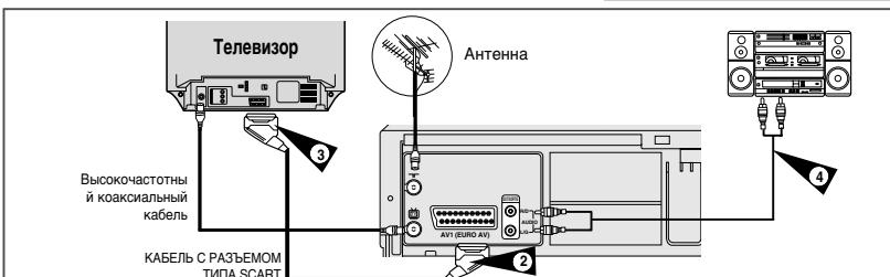
Если ваш телевизор оборудован соответствующими входными разъемами, вы также можете подключить ваш видеомагнитофон к телевизору с использованием кабеля с разъемами типа SCART ("тиольпан"). Зачет этого вы:
