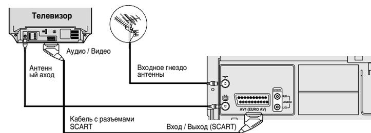
Подключение другого видеомagneтoфона, поддерживающего функции EasyLink / nexTVViewLink / AV-Link.
