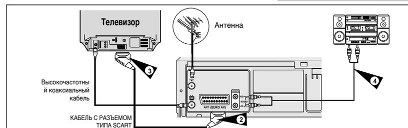
Если ваш телевизор оборудован соответствующими входными разъемами, вы также можете подключить ваш видеомagnитoфон к телевизору с использованием кабеля с разъемами типа SCART ("тюльпан"). За счет этого вы:
