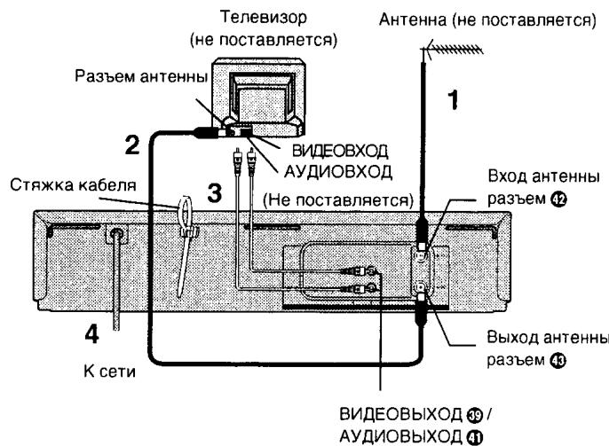
ВКМ подает сигнал на телевизор по коаксиальному кабелю RF на канал Е21-Е69.
