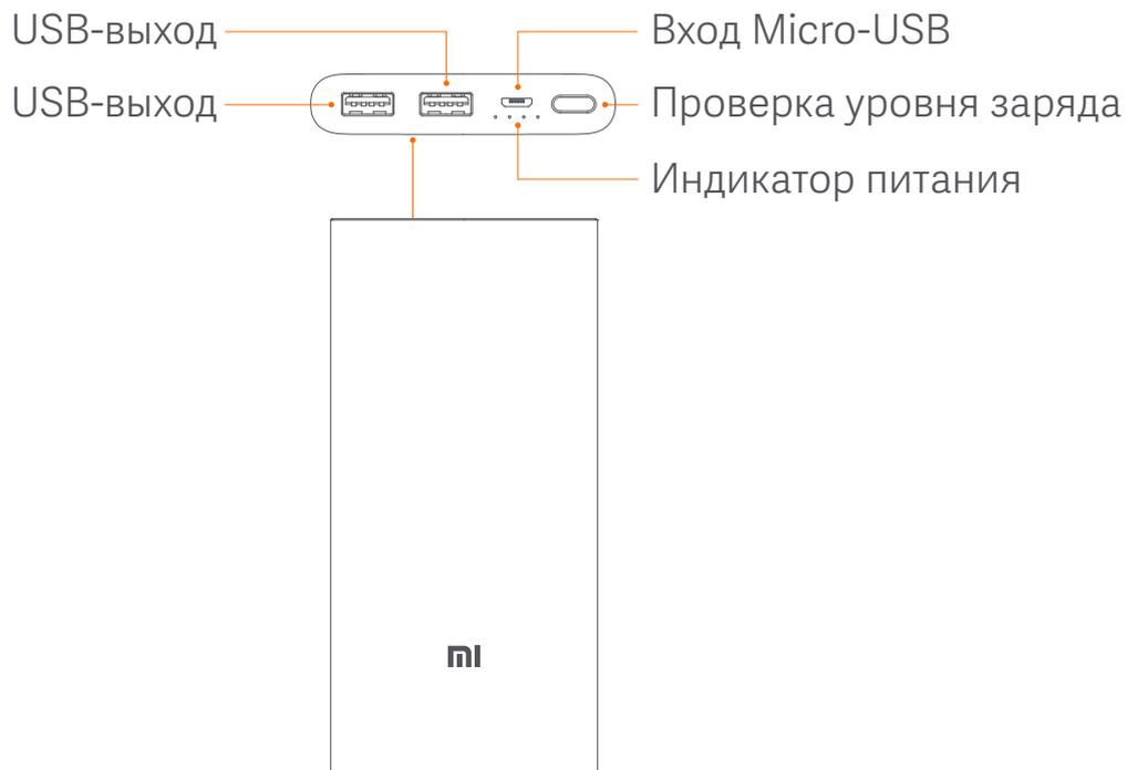
Кнопка проверки уровня заряда не является кнопкой питания. Внешний аккумулятор на 10000мАч Mi Power Bank 2S определяет состояние зарядки и разрядки автоматически. Индикатор питания гаснет через 2 минуты после полной разрядки.
