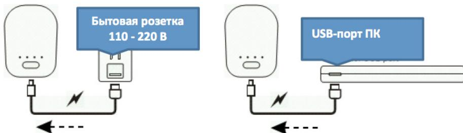
Аккумуляторды зарядтау үшін оны micro USB кіріс ұяшығы арқылы розеткаға немесе дербес компьютердің USB портына қосыңыз. Зарядтау кезінде аккумулятордың корпусындағы индикаторлар көк түспен жанады.
