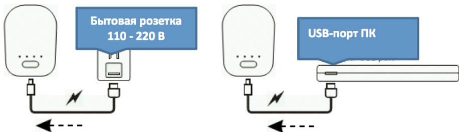
Для того, чтобы начать зарядку аккумулятора, подключите его через вход micro USB к розетке или USB порту персонального компьютера. В процессе зарядки на корпусе аккумулятора будут гореть индикаторы синего цвета.
