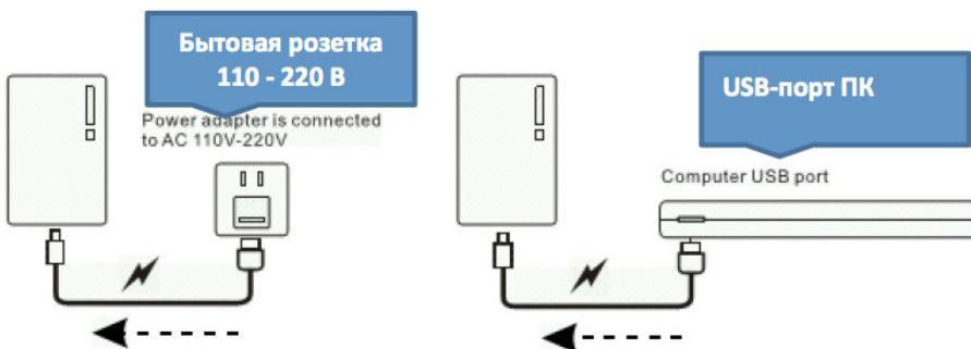
Для того, чтобы начать зарядку аккумулятора, подключите его через вход micro USB к розетке или USB порту персонального компьютера. В процессе зарядки на корпусе аккумулятора будут гореть индикаторы синего цвета.
