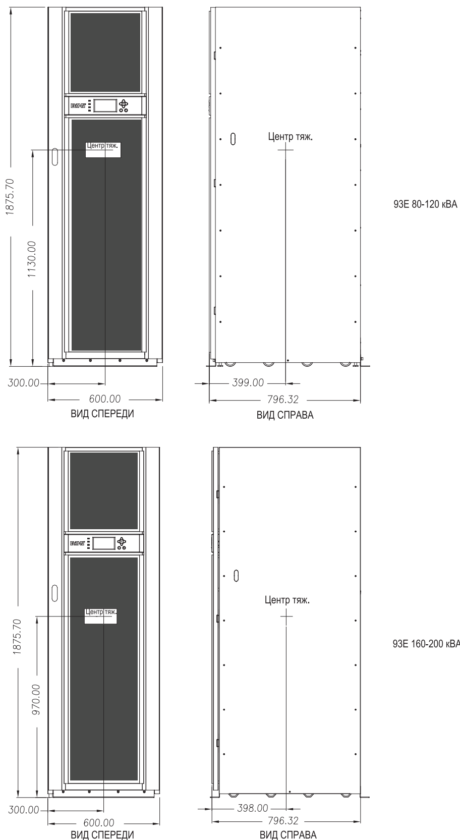
Рис. 3-3: Центр тяжести шкафа ИБП
