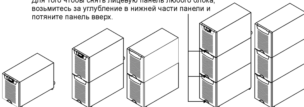
Рисунок 5. ИБП и внешние батарейные шкафы
