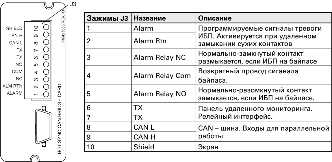
Рисунок 44. Плата XSlot Hot Sync и контактный интерфейс
