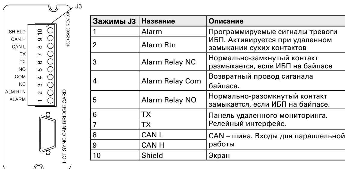
Рисунок 44. Плата XSlot Hot Sync и контактный интерфейс
