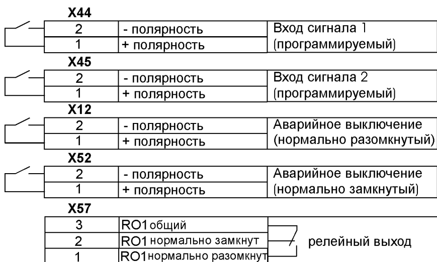
Рисунок 22. Подключение к ИБП кабелей внешних управляющих устройств
