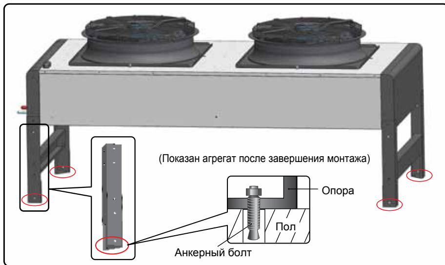
Рис. 3-9 Установка наружного блока на опоры
