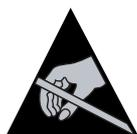
**Предупреждение:** несоблюдение данного указания может повлечь за собой повреждение агрегата, травму или угрозу жизни вследствие разряда статического электричества. Электронные компоненты управления увлажнителем очень чувствительны к разрядам статического электричества. Для того, чтобы защитить эти компоненты во время монтажа и обслуживания, необходимо принять меры против разряда статического электричества.
