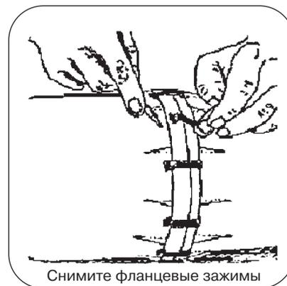
Снимите фланцевые зажимы
