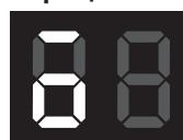
Il lampeggio della barra in alto a sinistra indica la saturazione del filtro grassi.
