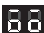
Il lampeggio di entrambe le barre indica la saturazione dei due filtri.
