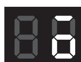
Il lampeggio della barra in alto a destra indica la saturazione del filtro odori.
