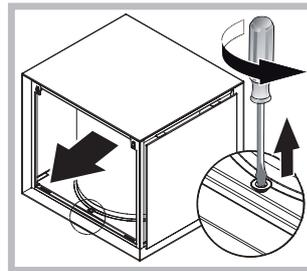
Вийміть фіксувальний гвинт фільтру за допомогою відповідного інструменту і витягніть його двома руками. Рекомендується надіти захисні рукавички і скористатися драбинкою під час цих дій.
