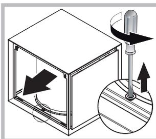
Открутите крепежный винт фильтра отверткой и выньте его обеими руками. Для выполнения этой операции рекомендуется использовать перчатки и лестницу.
