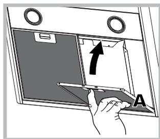
Май сүзгісі тағам пісірген кезде шығатын май бөлшектерін ұстайды; оны кем дегенде айына бір рет, әлсіз жуғыш затпен қолмен немесе төмен температуралы қысқа ыдыс жуғыш циклымен тазалау керек.
