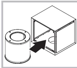
**Монтаж:** Вставте фільтр в капсулу, дотримуючись напрямку (порожниста частина фільтру має дивитися вбік витяжки).
