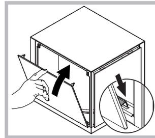
Прикрепите переднюю панель корпуса шпонками в нижней части и затем протолкните верхнюю часть панели так, чтобы штыри вошли в свои отверстия.
