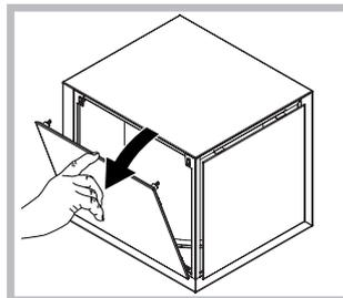
**Demontáž:** Odmontujte hornú časť čelného panelu skrinky, v ktorej sa nachádza filter, a potom ju úplne vyberte, aby ste sa dostali k valcovému filtru.
