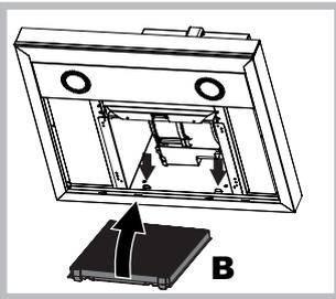
**Монтаж:** Вначале присоедините угольный фильтр к металлическим шпонкам в задней части вытяжки, затем в передней части, нажав на два рычажка.
