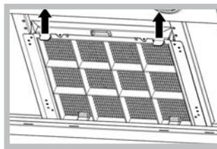
**Догляд за фільтром проти неприємних запахів High Performance. (Дизайн у вигляді: циліндричний фільтр + зовнішня капсула для прикрашення) \***
