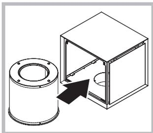
**Montáž:** Vložte nový filter do skrinky, pričom dávajte pozor na smer (dutá časť filtra musí byť obrátená smerom k odsávaču).
