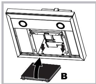
**Montáž:** Filtr s aktivním uhlím uchyťte nejdříve vzadu ke kovovým jazýčkům odsavače, a poté vpředu zatlačením dvou pák.
