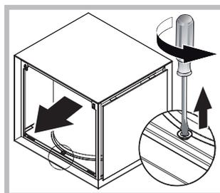
Odskrutkujte upevňovaciu skrutku filtra vhodným náradím a vyvlečte ho obidvomi rukami. Pri vykonávaní tejto operácie sa odporúča použiť rukavice a rebrík.
