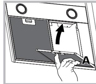
Жировой фильтр удерживает жирные частицы, содержащиеся в испарениях варочной панели при готовке. Необходимо чистить этот фильтр не реже одного раза в месяц неагрессивными моющими средствами вручную или в посудомоечной машине при низкой температуре по короткой программе. Для съема
