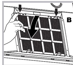
**Demontáž:** Vyměňte filtr s aktivním uhlím zatlačením dvou předních pák, kterými je připevněn k odsavači.
