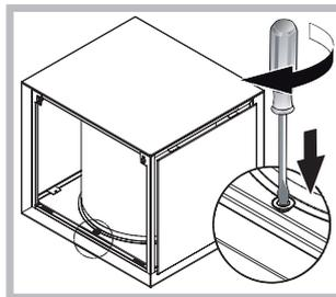
Закріпіть фільтр за допомогою фіксувального гвинта з комплекту постачання.
