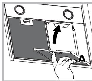
Фільтр-жироуловлювач поглинає жирові частинки, утворені в процесі готування; він має очищуватися один раз на місяць, за допомогою неагресивних миючих засобів, вручну або у посудомийній машині при низькій температурі та короткому циклі.
