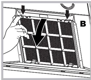
**Демонтаж:** Вийміть фільтр активованого вугілля, натиснувши на два передні важелі, які фіксують його до витяжки.
