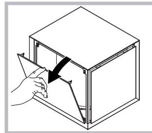
**Демонтаж:** Зверху від'єднайте фронтальну панель капсули, всередині котрої знаходиться фільтр, потім витягніть повністю капсулу і відкрийте її для доступу до циліндричного фільтру.
