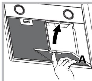
Protitukový filtr zachytává částice tuku pocházející z vaření; je třeba jej vyčistit nejméně jednou měsíčně neagresivními čisticími prostředky, manuálně nebo v myčce nádobí, při nízké teplotě a při použití krátkého cyklu.
