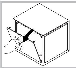
**Съем:** Отсоедините сверху переднюю панель корпуса, внутри которого расположен фильтр, затем полностью выньте его из корпуса для доступа к цилиндрическому фильтру.
