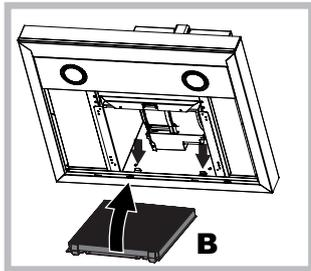
**Монтаж:** Приєднайте фільтр активованого вугілля спочатку позаду на металеві язички витяжки, потім попереду, натиснувши на два важелі.
