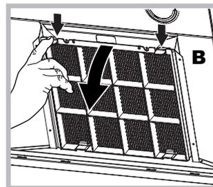
**Demontáž:** Vyberte filter s aktívnym uhlím zatlačením dvoch predných pák, ktorými je pripevnený o odsávač.
