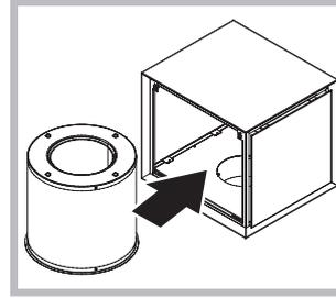
**Монтаж:** Вставьте фильтр в корпус в правильном направлении (полая сторона фильтра должна быть направлена к вытяжке).
