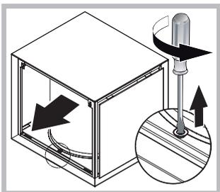
**Montáž:** Vložte nový filtr do skříňky a dávejte přitom pozor na směr (dutá část filtru musí být obrácena směrem k odsavači).
