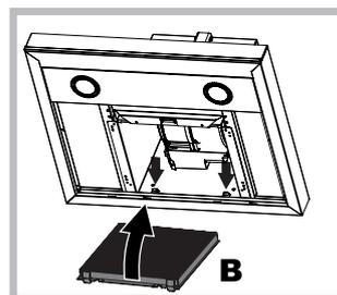
**Montáž:** Uchyťte filter s aktívnym uhlím najskôr vzadu o kovové jazyčky odsávača, a potom vpredu, zatlačením dvoch pák.
