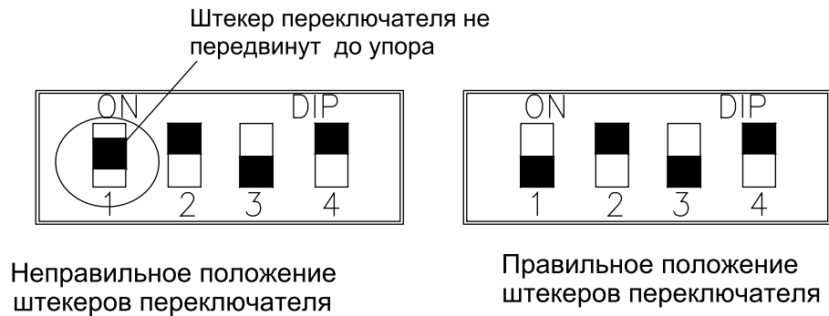
Рисунок 11.3 — Выставление адресного кода на DIP переключателе
