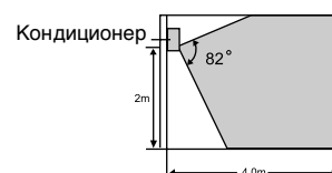
Высота установки кондиционера более 2 м
