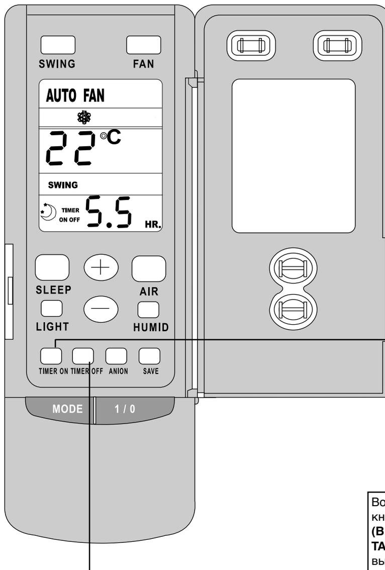
При остановке нажмите кнопку **TIMER ON (ВКЛЮЧЕНИЕ по ТАЙМЕРУ)**, установите время включения кондиционера в диапазоне 0–24 часа для автоматического включения кондиционера.
