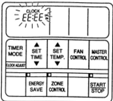
При возникновении какого-либо сбоя в работе кондиционер прекращает функционирование, а на дисплее панели управления вместо индикации текущего времени появляется надпись "EE:EE".
