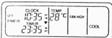
**Пример:** Время выключения кондиционера (OFF TIMER) установлено на 23:35.
