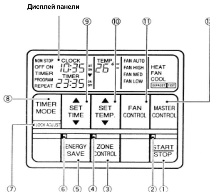
На данном рисунке все индикаторы дисплея изображены работающими. При реальном использовании кондиционера отображаются только те индикаторы, которые задействованы в текущий момент.
