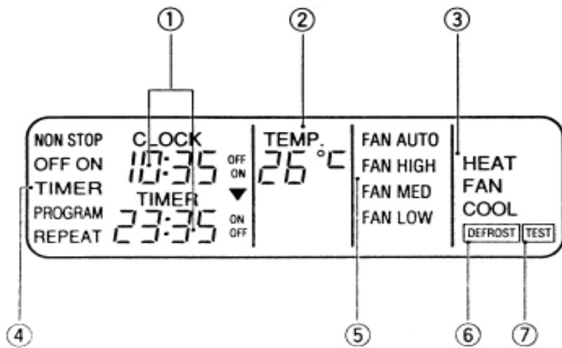
На данном рисунке все индикаторы дисплея изображены работающими. При реальном использовании кондиционера отображаются только те индикаторы, которые задействованы в текущий момент.
