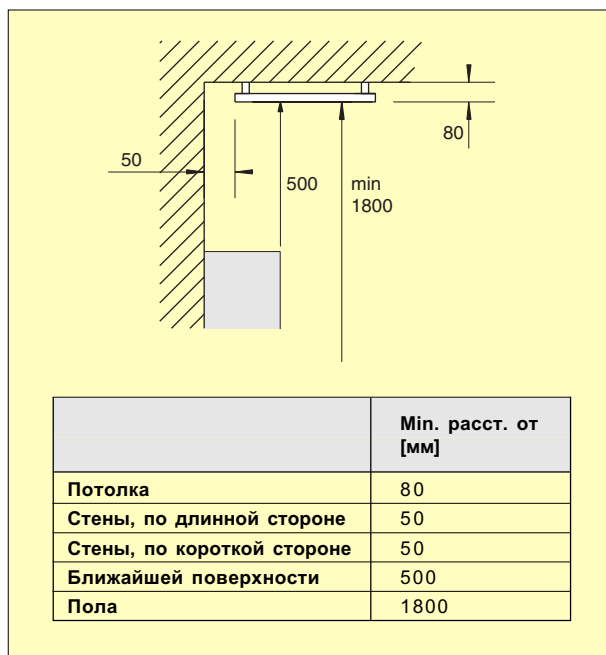
Рисунок. 2: Минимальные расстояния при установке.
