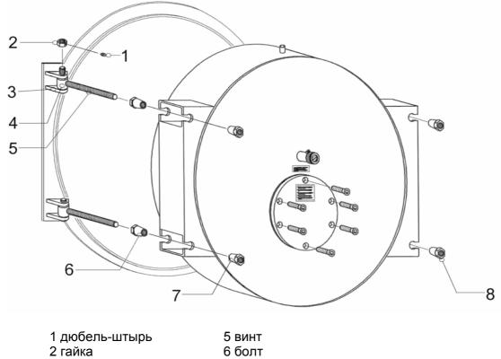
1 дюбель-штырь5 винт2 гайка6 болт3 опоры петель7 болт4 петельные штыри8 болт
