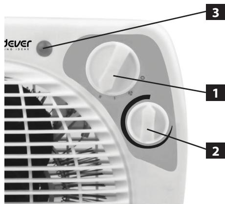
Когда температура помещения достигнет желаемого уровня, поверните ручку термостата (2) против часовой стрелки до тех пор, пока прибор не выключится (индикатор работы (3) выключится). После этого температура в помещении будет поддерживаться автоматически, периодически включая и выключая вентилятор.
