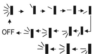
При каждом нажатии этой кнопки включается очредной режим и загорается соответствующий индикатор.
