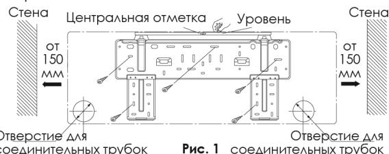
Рис. 1 соединительных трубок
