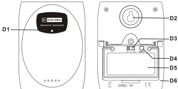
D1: Светодиод передачи сигнала
