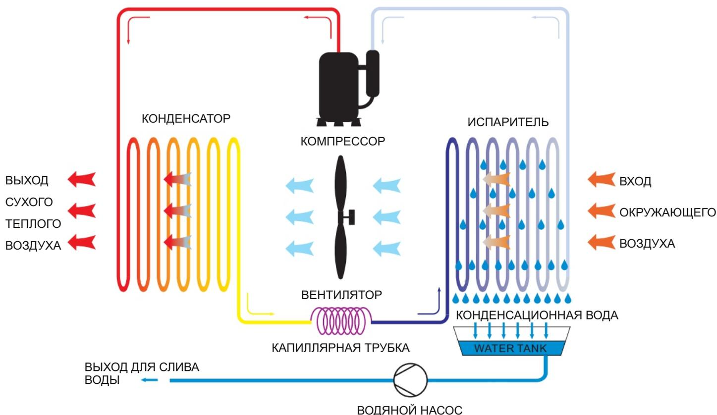
В осушителе используется холодильный контур для преобразования влажного воздуха в теплый сухой воздух. При прохождении влажного воздуха через конденсатор содержащаяся в нем вода конденсируется, и воздух становится сухим.
