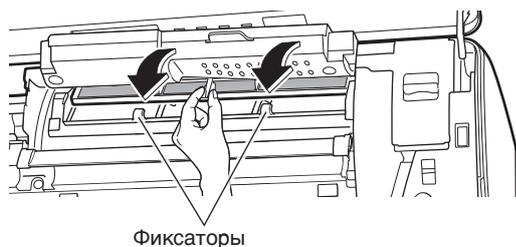
ОЧИСТКА ФИЛЬТРА не выполняется нужным образом, если фотокаталитический фильтр для очистки и дезодорирования воздуха неправильно установлен. После очистки нужно включить ОЧИСТКУ ФИЛЬТРА, чтобы воздушный фильтр работал нормально. ► Стр. 28
