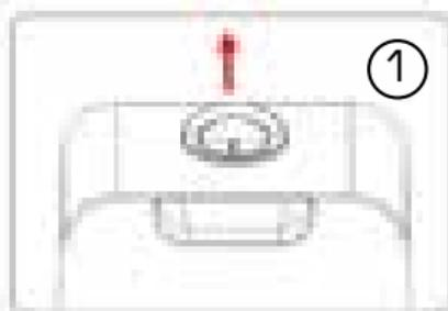
Снимите сопло. Возьмитесь за ручку резервуара для воды и снимите его с корпуса.
