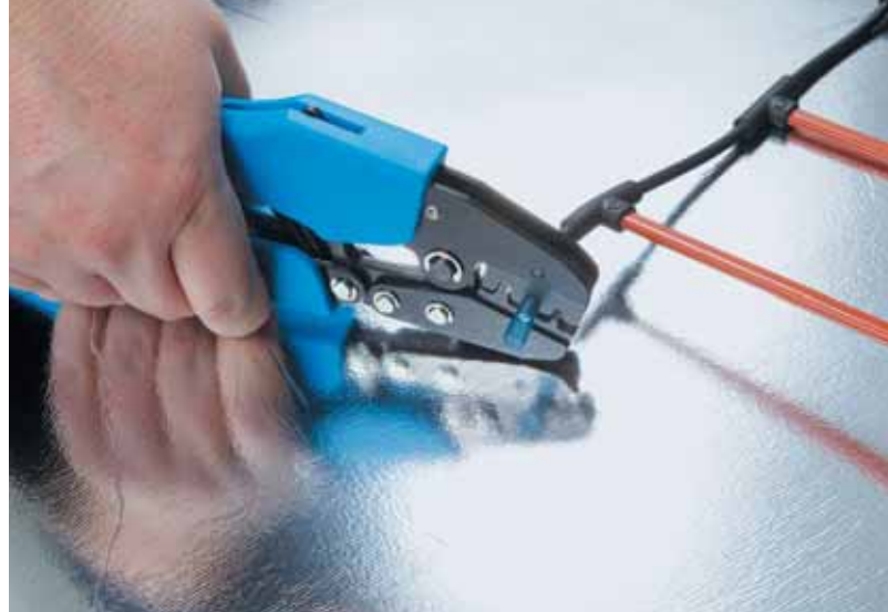
Рис. 9. Зажатие гильзы в термоусаживаемой трубке
