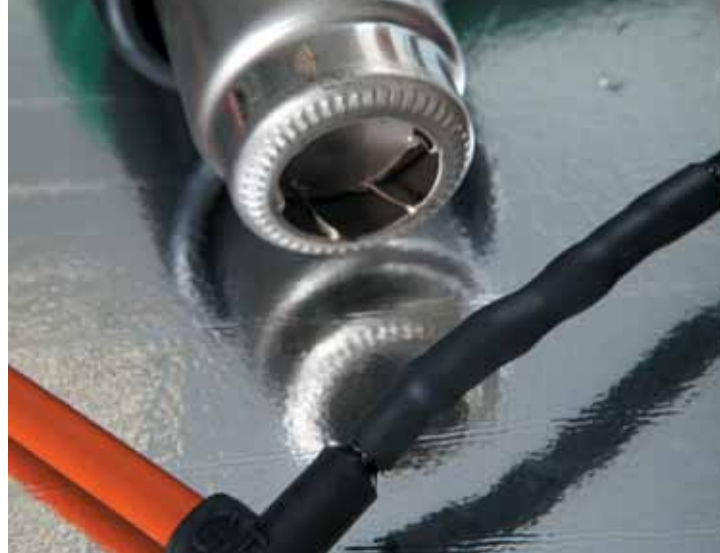
Рис. 13. Усадка термоусаживаемой трубки техническим феном
