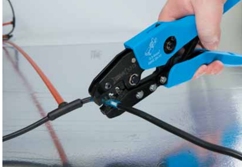
Рис. 11. Обжатие клещами соединительной гильзы
