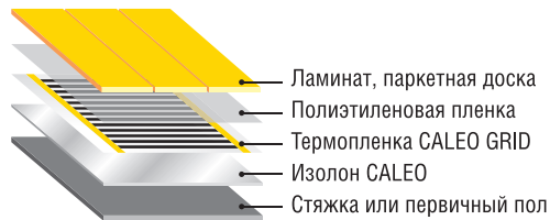
Рис. 28. Схема монтажа теплого пола CALEO под ламинат или паркетную доску
