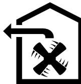
Втянутый воздух очищается жирулавливающим фильтром и подаётся по системе труб наружу.
