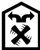
Всасываемый воздух проходит через жирулавливающие фильтры и фильтр с активированным углём и очищенным выводится обратно в кухню.
