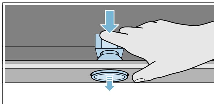
4. Поверните лампу на четверть оборота против часовой стрелки и выньте её.
