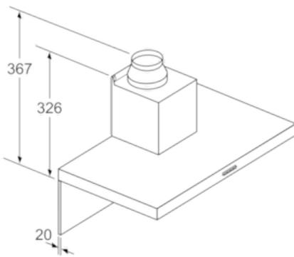
При наличии задней стенки необходимо учитывать конструкцию прибора.
